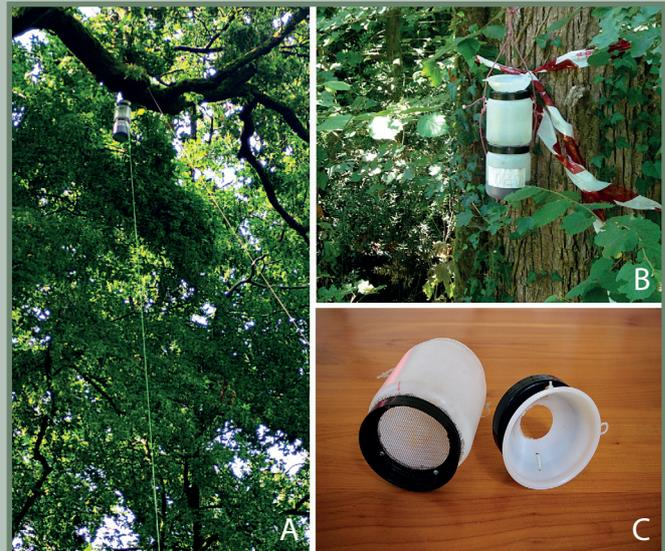
Fig. 4 Posizionamento di una coppia di trappole, alle due altezze previste A. su branca ad oltre 10 m; B. sul tronco a 1,5 - 2 m; C. dettaglio costruttivo del coperchio modificato con imbuto e flacone modificato a camera di raccolta (Foto M. Bardiani).
